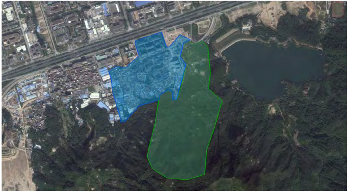
25 河排街水浸黑点汇水范围
