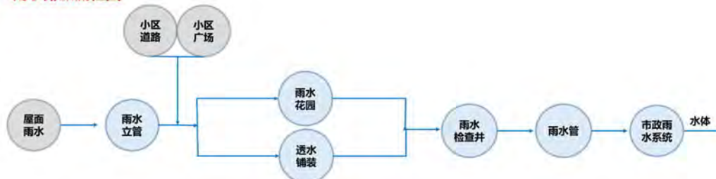
图 2-2 雨水排放流程图
