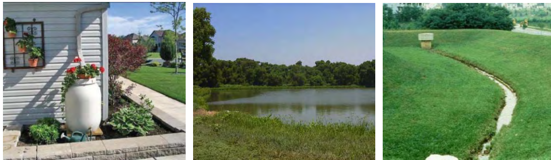
图 6-7 雨水罐、雨水湿塘、雨水干塘
