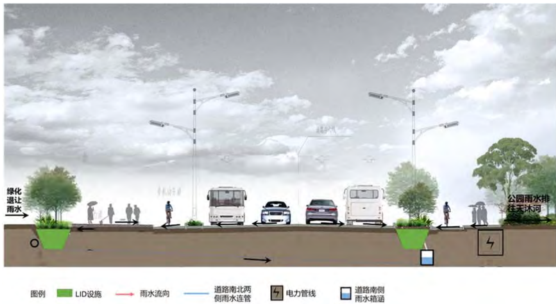
图 4-9 横断面 LID 布置示意图
