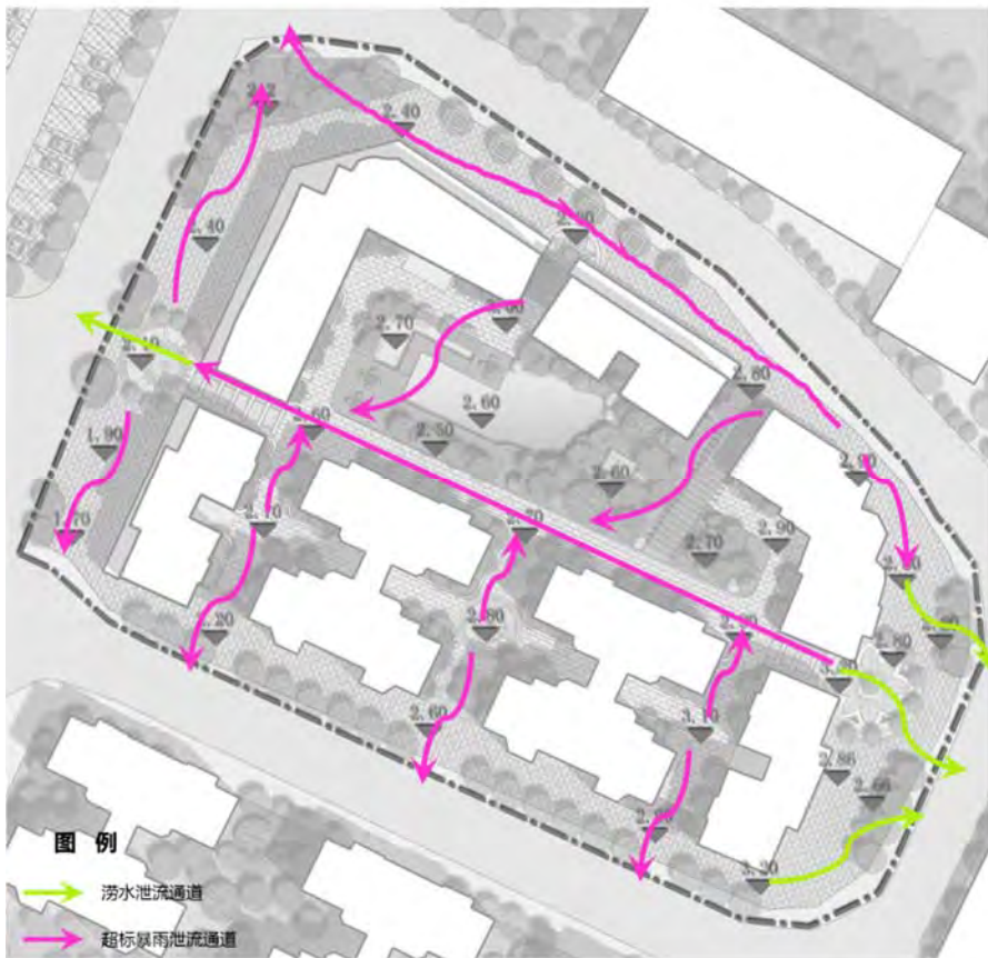
图 2-10 涝水泄流通道设计图
