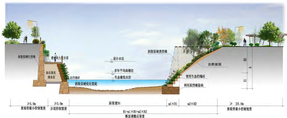
图 6-7 现状河道改造示意图（单侧改造-单侧用地条件充裕）
