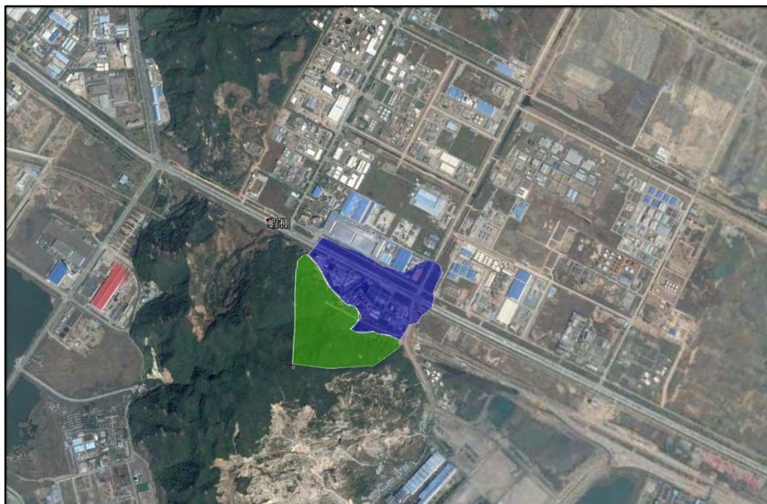
50 电厂南路及石化七路路口水浸黑点汇水范围
