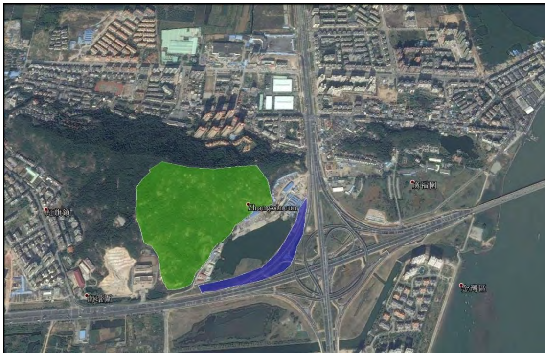
48 金湾互通立交西侧便道水浸黑点汇水范围
